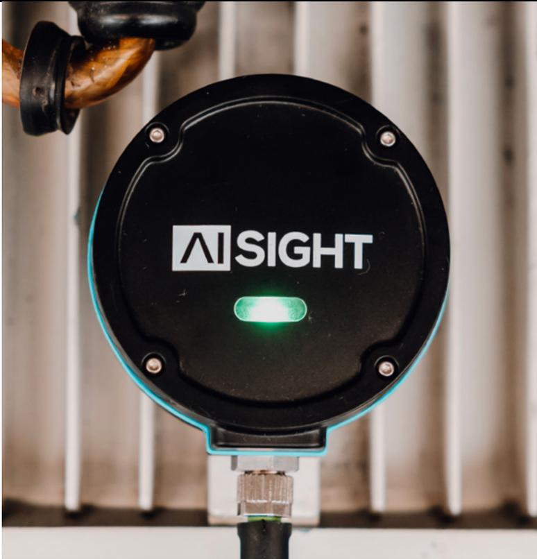
**AION**, verwendet drei Sensoren, welche eine Analyse in allen Dimensionen ermöglicht. Dadurch sind wir in der Lage Störungen und Fehler wie beispielsweise Fehlausrichtungen frühzeitig zu erkennen.
